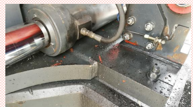
正面吊转向油缸油管接头渗油
